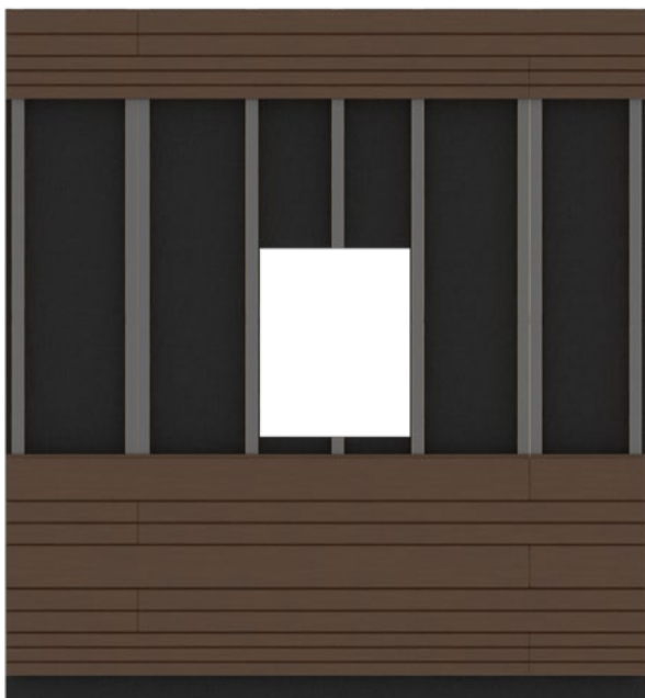
Pose en quinconce
