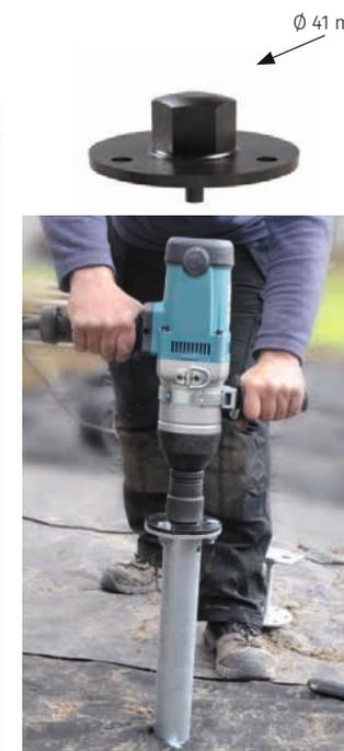
**ADAPTATEUR POUR BOULONNEUSE A CHOC**
